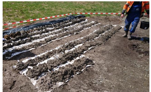
Schichtenansprache nach Aufschlussbohrung zur Festlegung der Brunnendimensionierung
